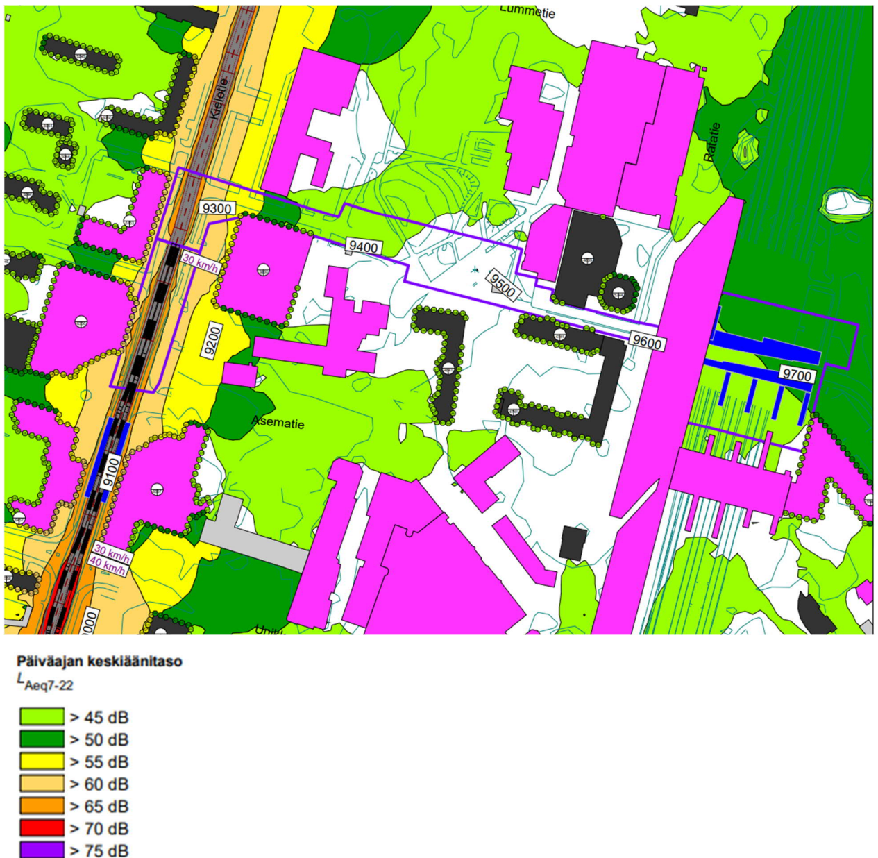
Kuva 23. Ote tieliikennemelun ja raitiotien yhteismelun päiväaikaisesta ennustetilanteesta suunnittelualueella (Sitowise Oy 20.12.2021). Kuvassa rautatieliikenteen melua eikä tunnelin yläpuolisten katujen melua ei ole mallinnettu, koska niillä ei ole yhteisvaikutusta tunnelissa sijaitsevan raitiomelun kanssa.
