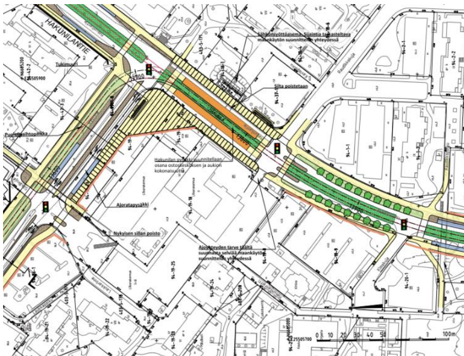
Kuva 18. Ote Vantaan ratikan yleissuunnitelmasta (WSP Finland, 30.4.2019). Kuva Hakunilantiestä sekä Kyytitien ja Kyytitien risteyksialueelta. Raitiotiepysäkin odotustilan on merkitty oranssilla ja bussipysäkin odotustila sinisellä.
