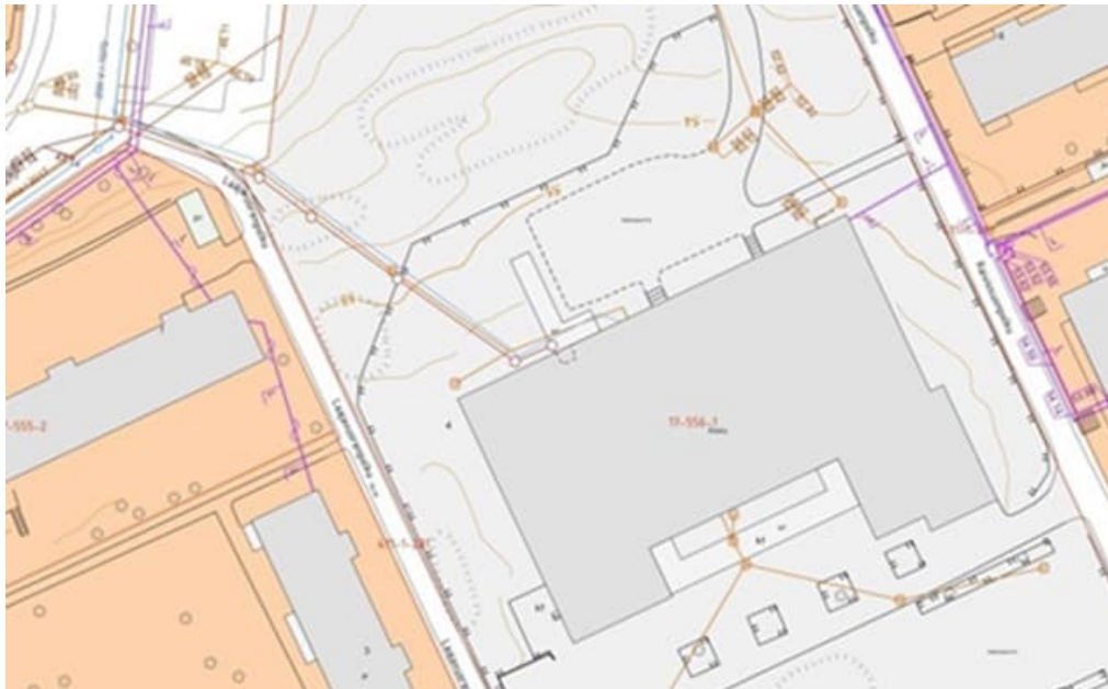
Kuva 1; Kiinteistön nykyiset kaukolämpö-, vesi-, viemäri- ja hulevesitonttijohdot
