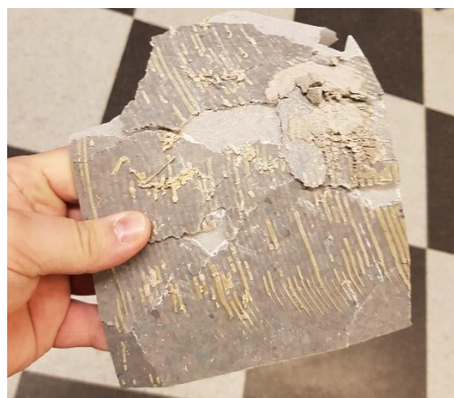
Kuva 28. Tilan 22 (VM1) muovimaton alla oli voimakas mikrobiperäinen haju.
