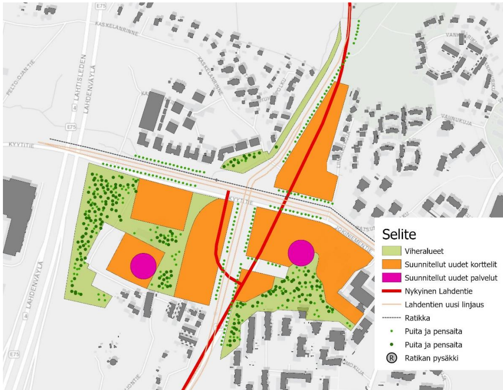
Kuva 26. Kaavio Hakunilan keskustan laajennus 2 LUONNOKSEN esittämistä maankäytöllisistä muutoksista sekä Lahdentien nykyinen linjaus (punaisella). Lahdentien linjauksen siirtäminen va-pauttaa runsaasti kehitettävää maapohjaa suunnittelualueella.
