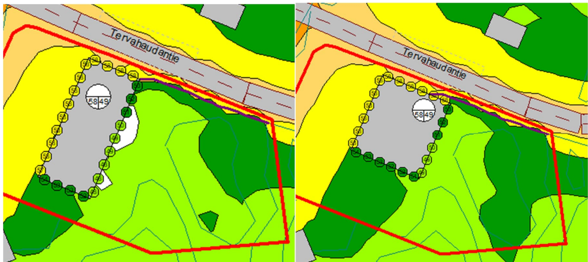
Kuva 5. Tontin pohjoisreunan meluntorjunta 2,15 m korkealla melusteellä.
