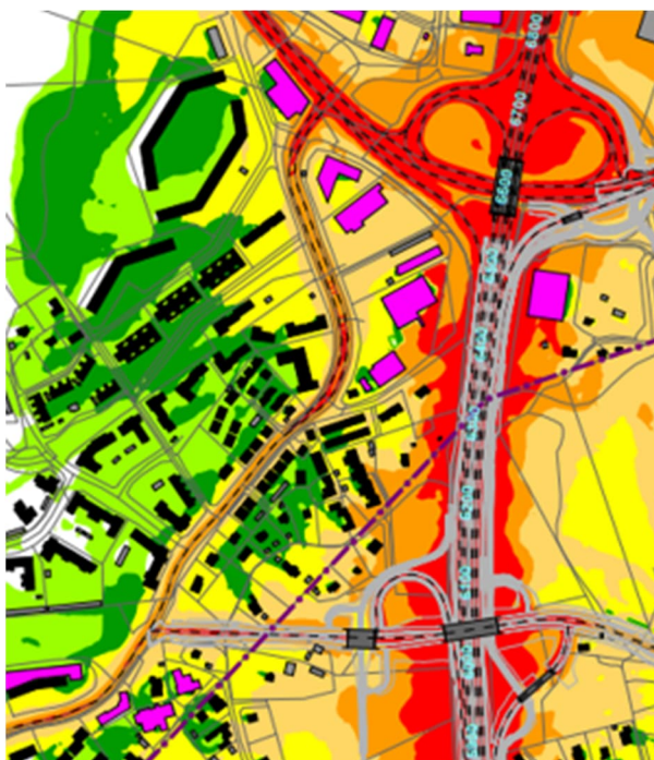
3. Ennustetilanne 2050, tie- ja katumelu. Tiesuunnitelman järjestelyt, vain nykyinen meluntorjunta (teoreettinen vertailutarkastelu). Päiväajan klo 7–22 keskiäänitaso (Laeq) 2 m korkeudella maanpinnasta. Ramboll 7.12.2020
