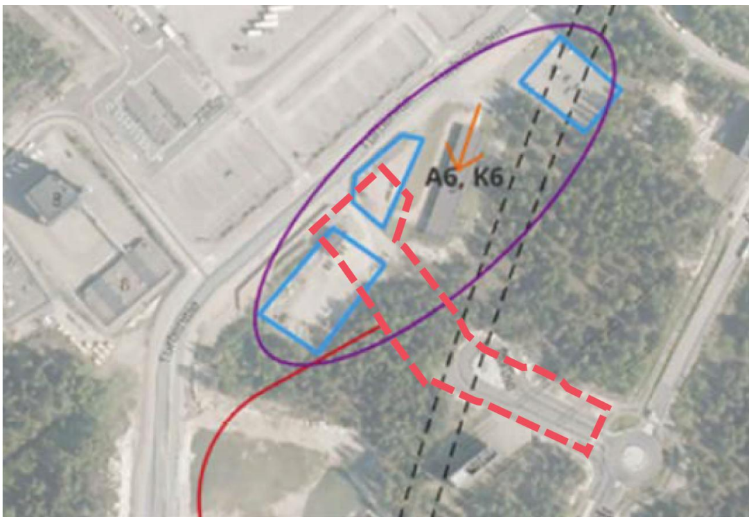
Kuva 26. Tarkastelu Lentoradan kuilun mahdollisista sijainneista kaavamuutosalueella ja sen läheisyydessä (K6, siniset viivat, kolme vaihtoehtoa) ja ajotunnelista (A6, oranssi nuoli). Tunnelin linjaus
