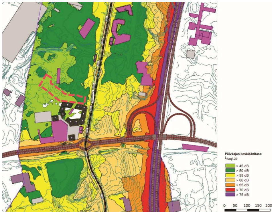
Kuva 32. Ote tieliikennemelun ja raitiotien yhteismelun päiväaikaisesta ennustetilanteesta suunnittelualueella. ( Sitowise 31.1.2023 ) Kaavamuutosalueen likimääräinen sijainti on esitetty kuvassa punaisella pistekatkoviivalla.
