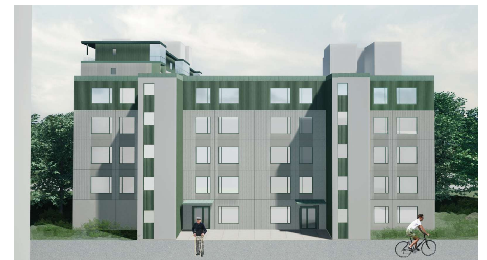
Esimerkki rakennuksen korottamisesta ja porrahuonelaajennuksesta yleiskaavan arvokkaan kulttuuriympäristön alueella. Suunnitelmassa on mukailtu vanhan julkisivun korosteväriä, tekstuuria ja aukotusta. Kuva: Suvi Raski, 2025.
