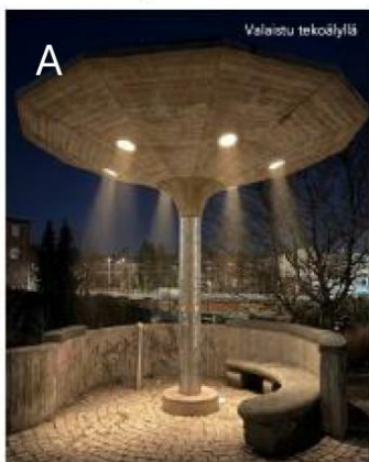
Esimerkkivalaisin WE-EF DOC 110 LED 2700K Medium beam 6-12W
